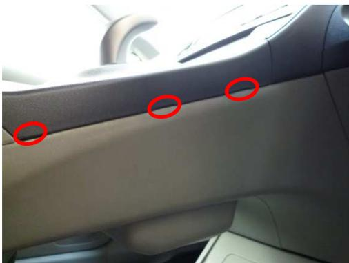
③三角パネルの側面にある3カ所の凹み部分を確認します。
