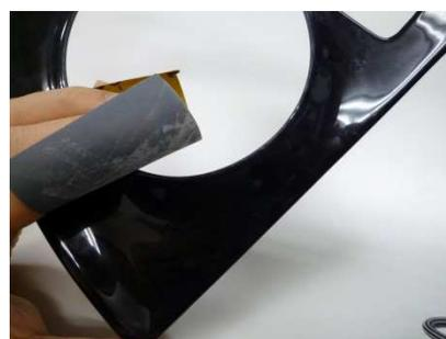
パネルカバーを装着していると【D】および【B】ボタンを押せるクリアランスがなくなってしまう場合があるので、その場合はパネルの円部分(赤○部分)を0.5~1mmほどやすり等で削って広げて下さい。※削り幅はパネルの製造メーカーによって異なりますので、ボタンの動作を確認しながら少しずつ削って下さい。削った所は耐水ペーパーなどで滑らかになるように仕上げして下さい。
