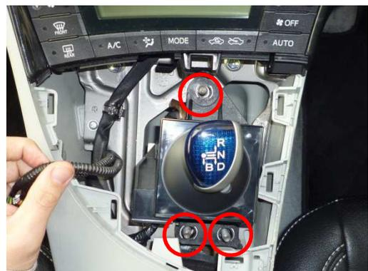
⑥純正シフトレバーを固定しているネジ(3個)をラチェットレンチで外します。
