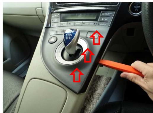
④3カ所の溝にヘラを挿し込み、パネルを少しずつ持ち上げて外します。
