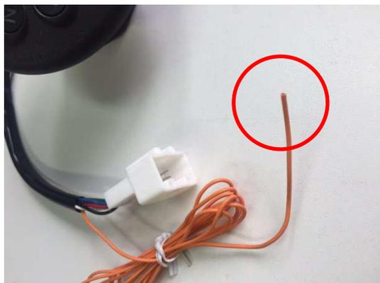
スマートポジションスイッチ本体から出ている橙線を付属のエレクトロタップ等を利用して、車両のイルミネーション電源に接続すると、イルミネーション(スモールライト)ON時は、各ボタンの照度が連動して減光するようになります。カーナビ裏やヒューズボックス等からイルミネーション配線に接続して下さい。
